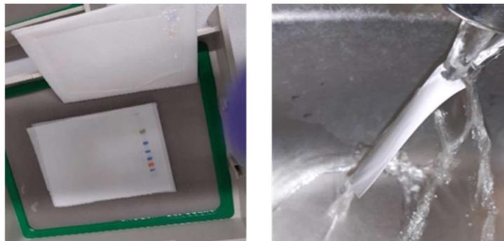
Abbildung 10: Blot-Membran nach Transfer mit Wasser gespült.
